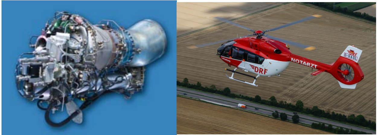
ARRIEL 2E – Moteur SAFRAN HELICOPTER ENGINES EQUIPANT LE H145 AIRBUS HELICOPTERS
